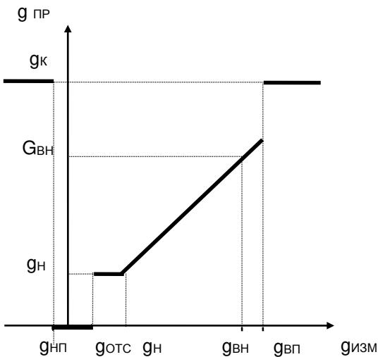
Рисунок 2.5 – Преобразование измеренных значений массового расхода
