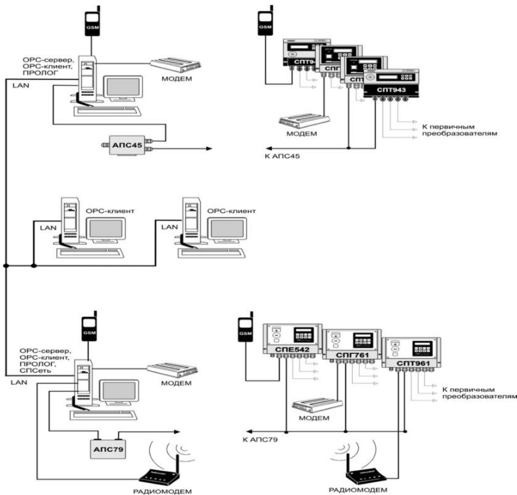
Рисунок 2.2 – Система информационного обеспечения учета энергоресурсов
