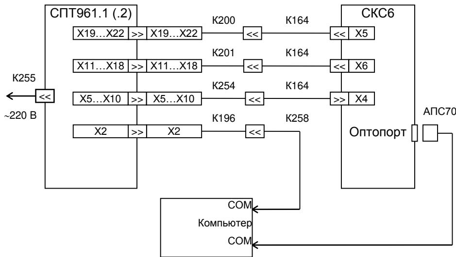
Рисунок 9.1 Схема проверки
