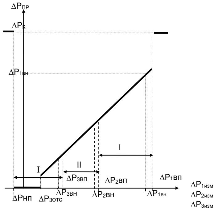
Рисунок 2.8 – Преобразование значений перепада давления, измеренных тремя датчиками
