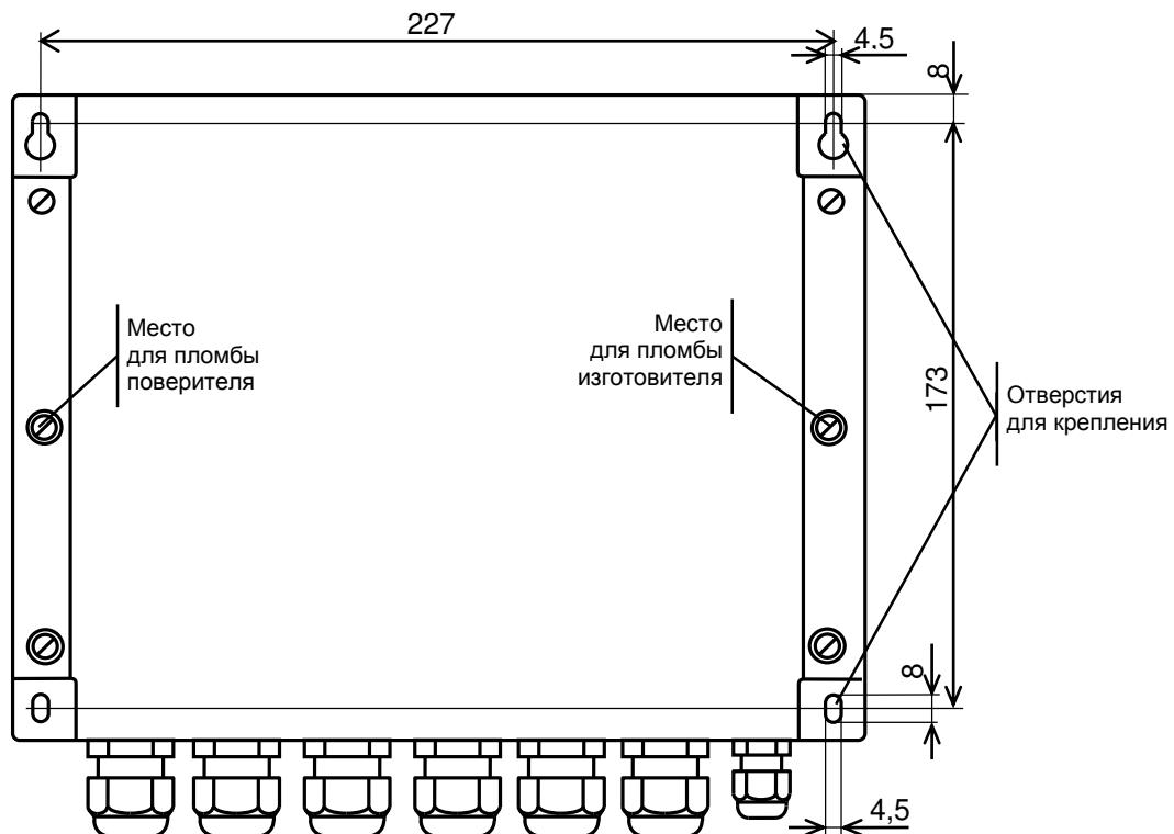
Рисунок 3.3 – Вид сзади
