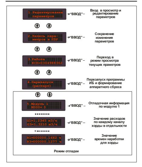
Рисунок 13 Схема управления индикацией режима просмотра и редактирования программируемых параметров
